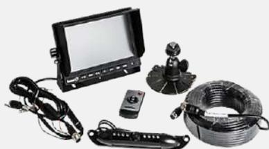
La telecamera per visione notturna del sistema è dotata di un angolo di visione di 120°. Si monta sulla targa utilizzando i fori della targa OEM del veicolo, senza bisogno di forare. Il monitor a colori da 7 pollici visualizza a una risoluzione di 800x480 ed è dotato di più supporti per adattarsi a molte configurazioni. È inoltre incluso un telecomando wireless con una portata di 3 mt e un cavo da 19 mt. La telecamera è classificata IP68 per la resistenza all'acqua e alla polvere
