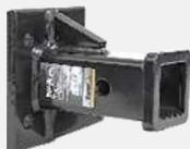
Si fissa facilmente e direttamente a qualsiasi piastra di attacco. Questo tubo ricevitore è saldato a una piastra di montaggio e verniciato a polvere colore nero, per resistere alla corrosione. È dotato di un robusto collare in acciaio fuso e di un foro per perno
