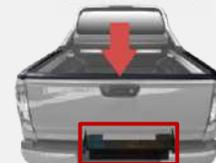
L'extender aumenta la superficie di appoggio, per poter montare più facilmente, nei mezzi dove non hanno appoggio sufficiente. L'extender è facile da installare ( usando la bulloneria in dotazione allo spargisale) e non richiede alcuna modifica al veicolo su cui viene installato.
